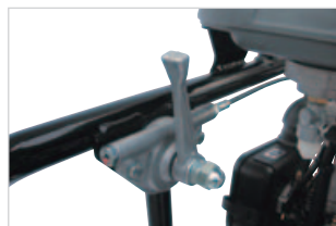
Leva acceleratore originale Mikasa in alluminio pressofuso
