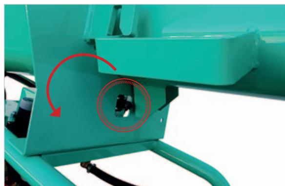
Sensore di sicurezza apertura camera di miscelazione
