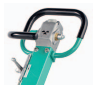
Dispositivo idraulico a leva singola per l'avanzamento e la retromarcia.
