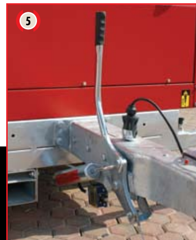
Freno con interruttore di sicurezza
