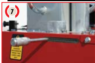
Blocco di rotazione con freno del tipo "a frizione"
