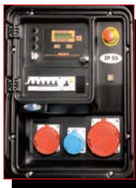
Quadro di distribuzione MCP 120-16 in ABS con prese di tensione protette da interruttori magnetotermici e differenziale 0,03 A (standard per serie Enermax con potenze da 30 a 40 kVA continui)
