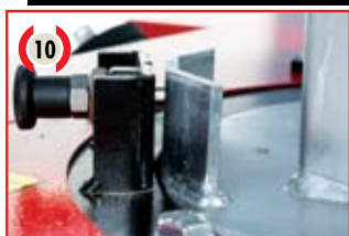
Blocco di sicurezza in caso di traino o di trasporto
