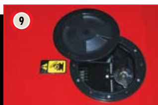
Oblò di tipo nautico per l'accesso al tappo del radiatore
